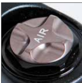
Air: Réglage pré-charge air
