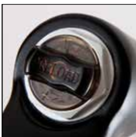
Coil: Réglage pré-charge ressort
