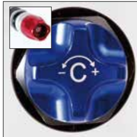
RC: Low Speed Druckstufe
